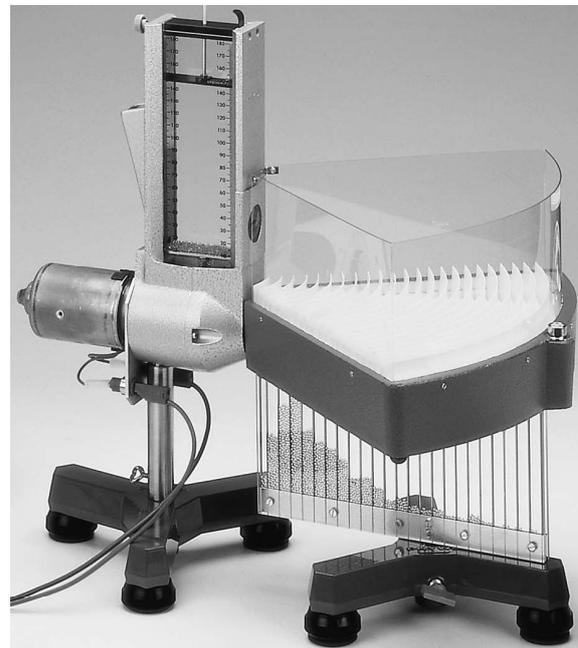
Abb. 9: Gerät zur kinetischen Gastheorie
