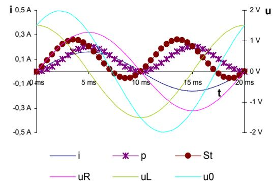
Abb.3: Wechselstromkreis mit Wirkwiderstand und Induktivität
