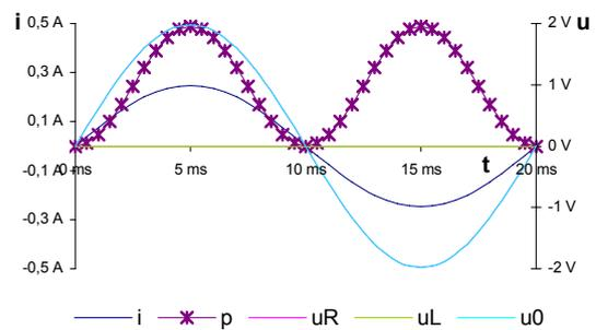
Abb.2: Wechselstromkreis mit Wirkwiderstand
