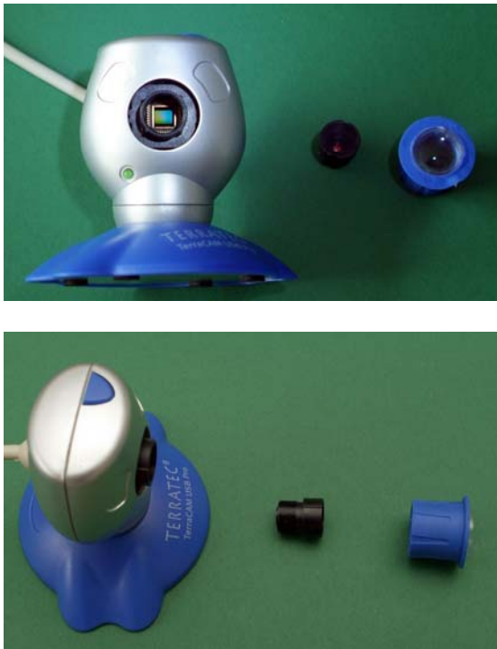
Abb. 6: Webcam (links), zugehöriges Objektiv (Mitte) und die eingesetzte Linse (rechts)
