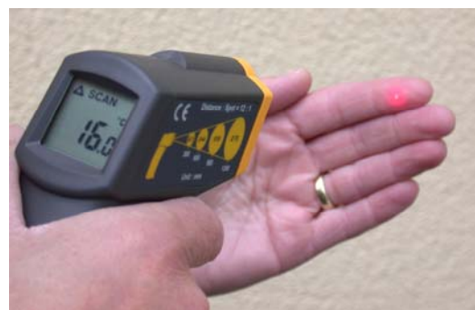
Abb. 7: Strahlungsthermometer (Achtung: Bei der Messung der Fingertemperatur ist der D/S-Wert des Gerätes zu beachten).
