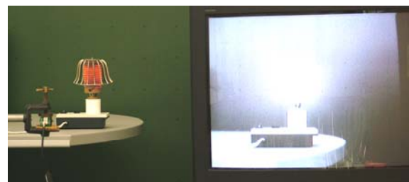
Abb. 10: Ein Heizstrahler, bei dem die Heizdrähte im sichtbaren Bereich schwach glühen und parallel dazu die Aufnahme mit der CMOS-Kamera.
