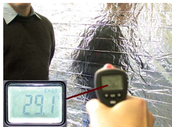
Abb. 8: Reflexion von Infrarotstrahlung an einer Rettungsdecke.
