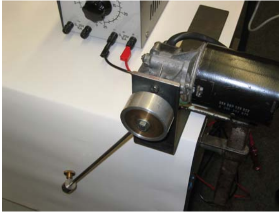
Abb. 4: Das Reibungspendel in einer gut laufenden Ausführung; Pendel bei max. Auslenkung.
