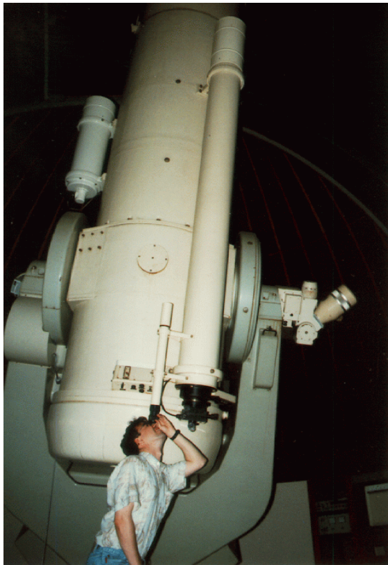
Abbildung 7: Ein Student identifiziert sein Beobachtungsobjekt am Sucherfernrohr des 90-cm-Teleskops der Universitäts-Sternwarte.
