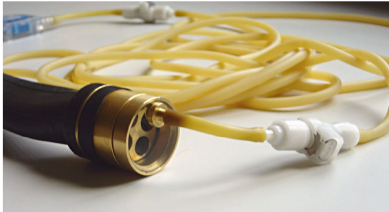
Abbildung 2: Pumpkammer mit Latexschlauch als Ader, der mit Steckverbindern angeschlossen ist.
