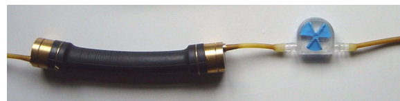
Abbildung 4: Pumpmodul mit Durchflussmesser
