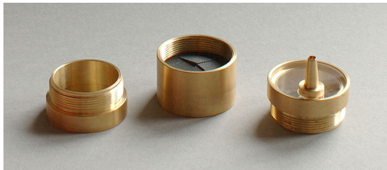
Abbildung 3: Aufbau der Ventile. Unter dem geschlitzten Gummi befindet sich eine durchbohrte Platte, die in Abbildung 2 sichtbar ist. Der transparente Deckel mit Schlauchanschluss kann auf beiden Seiten angeschraubt werden, so dass der Mechanismus wahlweise als Einlass- oder Auslassventil verwendet werden kann.
