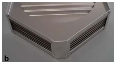
Abb. 3a und 3b: Detailaufnahmen des Aluminiumwärmetauschers: Oben erkennt man die schichtweise angeordneten Wärmetauscherbleche, die zur Vergrößerung der Oberfläche gefalzt sind (3a). In der Schichtenfolge wechseln sich Frischluft und Abluft ab. Unten (3b) ist eine Seite des Wärmetauschers zu erkennen, zu der ein Luftstrom ein und der andere austritt.
