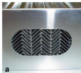
Abb. 2a und 2b: Zu Demonstrationszwecken geöffneter Wärmetauscher aus geriffelten Aluminiumblechen (2a, oben, Fa. Pluggit, [6]) und Wärmetauscherlamellen aus dünnem transparentem Kunststoff (2b, unten, Fa. Paul, [7]). Die Pfeile zeigen symbolisch den Verlauf der beiden gegenläufigen Luftströme.
