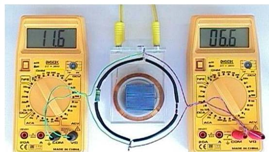
Abb.1: Verblüffenderweise zeigen zwei Voltmeter unterschiedliche Wechselspannungen an (in mV), obwohl sie an denselben Punkten eines stromdurchflossenen Widerstands-rings angeschlossen sind (vgl. Abb. 2). Das Verhältnis der Spannungen  $|U_{mess,1}/U_{mess,2}| \approx 1,76$  entspricht dem der Widerstände  $R_1 = 67,9 \Omega$  und  $R_2 = 38,5 \Omega$ .
