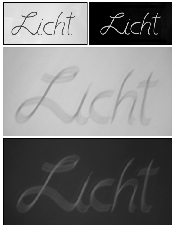
Abb. 11: Komplementäre Schattenbilder inverser Blenden. Der i-Punkt des Schriftzugs liefert ein dunkles (oben) und helles (unten) Bild der beleuchtenden Glühwendel, die etwa so orientiert ist wie in Abbildung 10 angegeben. Sie entspricht gewissermaßen dem Querschnitt der „Schattenfeder“ bzw. „Lichtfeder“, mit denen die Schriftzüge der Schattenbilder „geschrieben“ sind.
