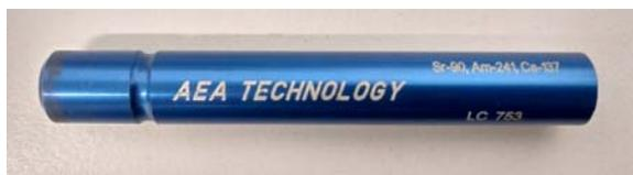
Abb. 3: Mischprobe. Links: Probenöffnung
