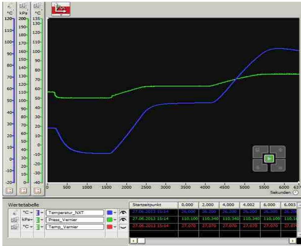
Abb. 6: Darstellung des zeitlichen Verlaufs der Temperatur- (blau) und Druckerhöhung bei der isochoren Zustandsänderung, relevante Messpunkte bei den konstanten Bereichen der Kurvenverläufe (Gleichgewichtszustände)
