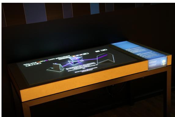
**Abb. 2:** Beispiel für ein durch Aufprojektion von tet.folio-Inhalten augmentiertes Experiment in der Ausstellung des Science Center Spectrum Berlin. Besucher:innen interagieren mit virtuellen Bedienelementen über eine kamera-gestützte Gestenerkennung.
